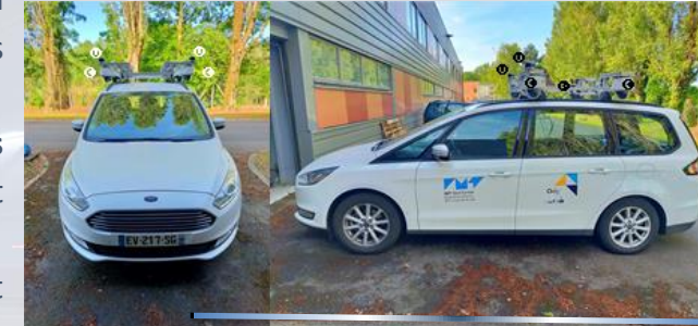
① Caméra PTZ haute résolution ② LIDAR 3D Velodyne ③ Radar Ultra Large Bande
